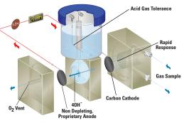
$0_2 + 2H_2O + 4e^- \rightarrow 4OH^-$  (cathode)  $4OH^- \rightarrow 0_2 + 2H_2O + 4e^-$  (anode)
